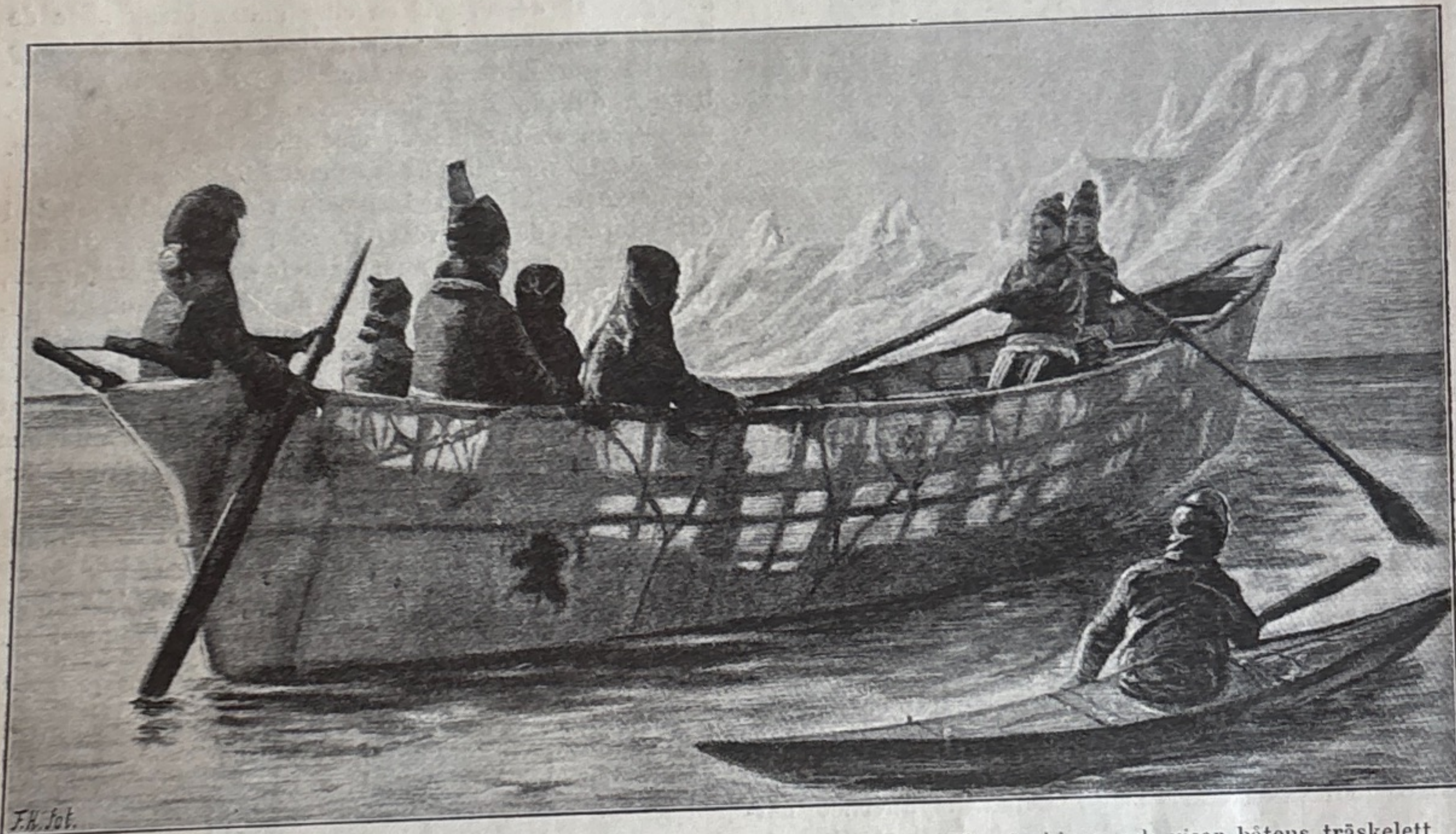
Fig. 71. Eskimå-kvinnor ro en »kinnobåt» genom hvars tunna skinnsidor solljuset skiner och visar båtens träskelett. Vid dess sida ses en man i en kajak. (Efter målning af Carl Rasmussen.)
